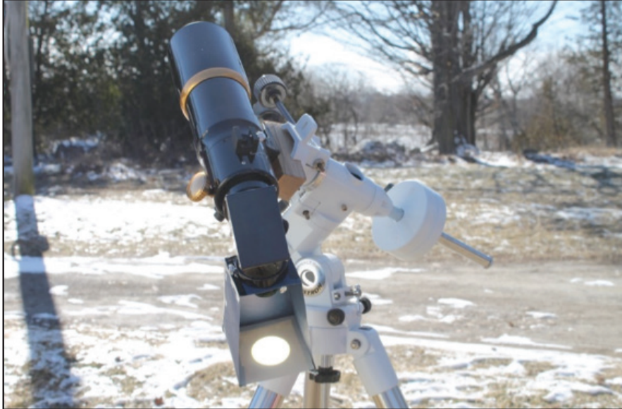
Proyección del ocular a través de un refractor usando una pirámide de Hossfield.
