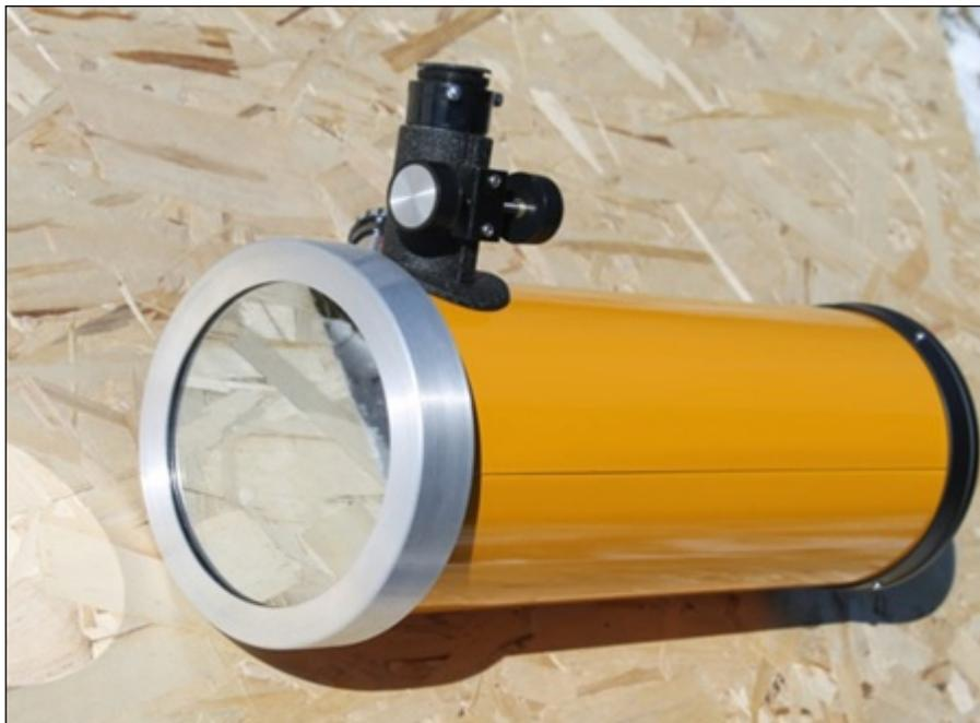
*O filtro solar encaixa firmemente sobre a abertura.*
