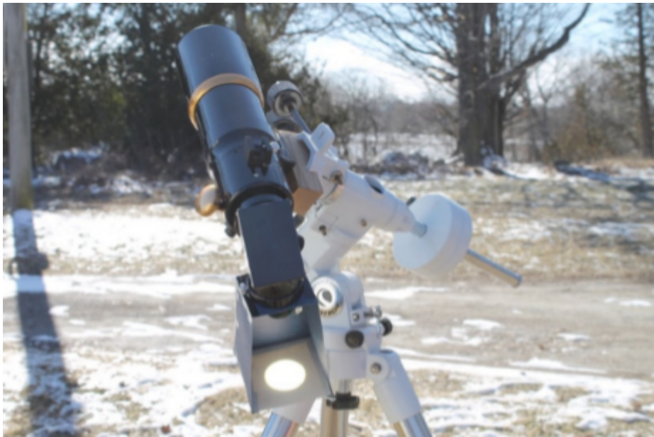
Projection oculaire à travers un réfracteur utilisant une pyramide de Hossfield.
