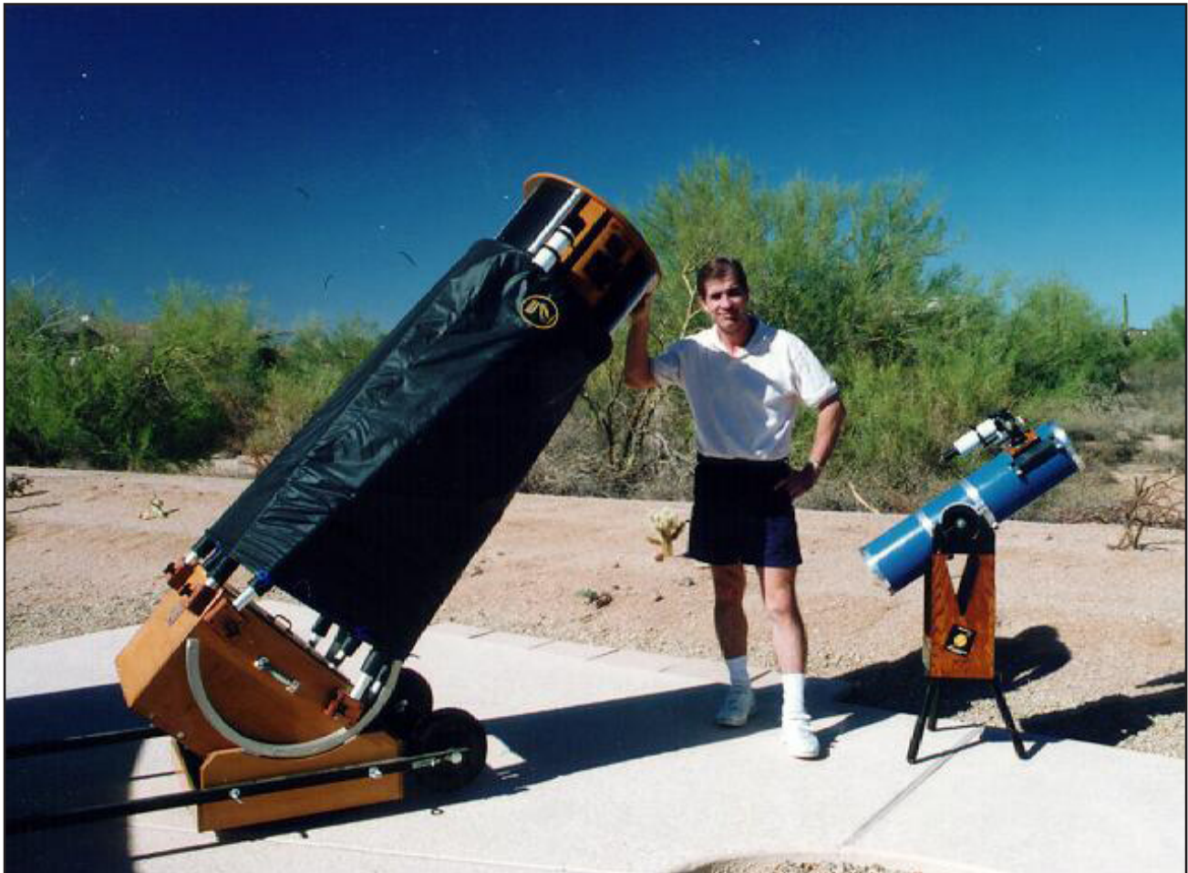
Gene Hanson, com seu telescópio refletor Obsession de 18" (457 mm) f/4.5; e seu telescópio refletor de 6" (152 m) f/5.
