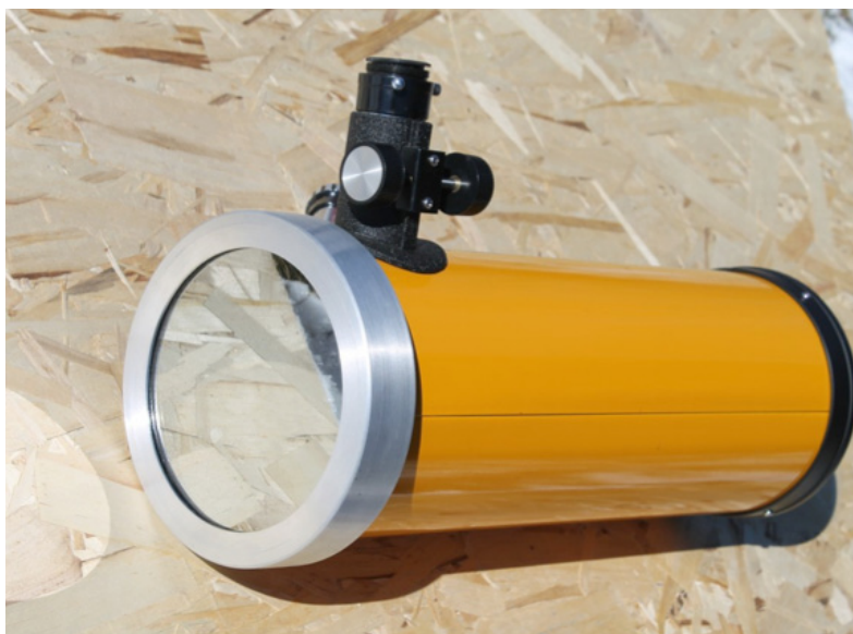
Filtro solare fissato all'apertura del telescopio.
